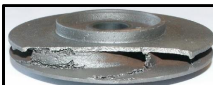
Figura 17. Rodete destrozado por episodios intensos de cavitación. Fuente: Wikipedia
